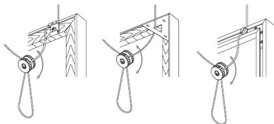
*La hauteur du tableau est réglable en bloquant la vis de réglage plastique.*
