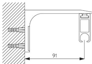
Vis SG 10492 (M4x8) nécessaire.
