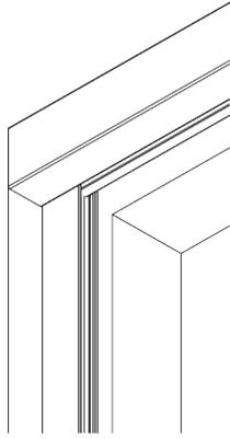
Profil de guidage SG 11542 en option à utiliser avec Fascia ou Boîtier.
