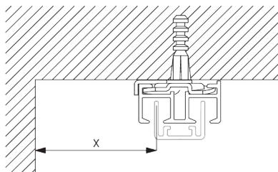
X: L'espace nécessaire dépend de l'avancée de possible
