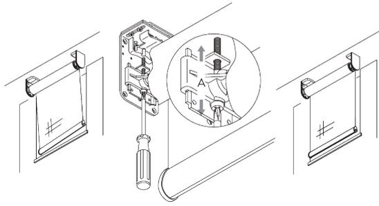
*Ajustement vertical du tissu par rapport au cadre de la fenêtre.*
